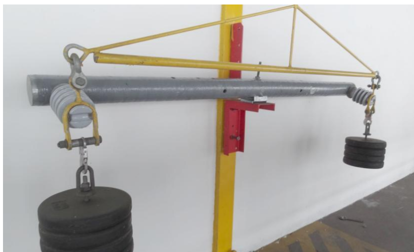
Foto 10 – Ensaio de Resistência à Torsão na cruzeta.
