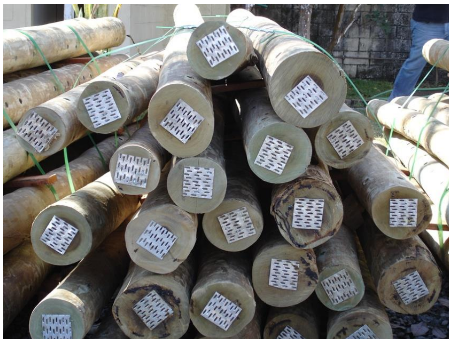
Foto 1 – Primeira aquisição de cruzetas roliças – alta sinuosidade e diâmetros incompatíveis.
