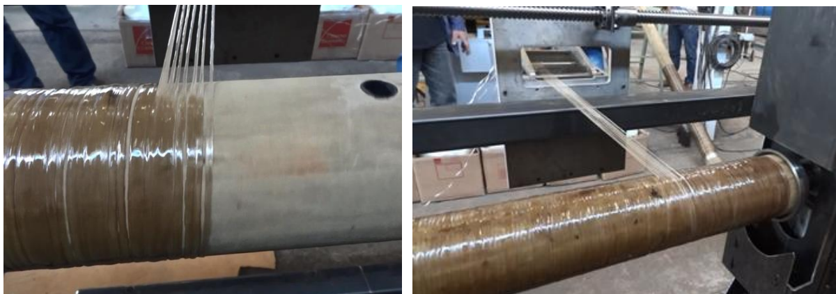
Fotos 5 e 6 – Fios contínuos de fibra de vidro, associados à resina específica, bobinados em ângulo, para maior resistência mecânica final.
