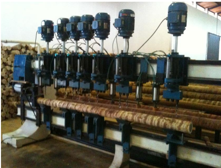
Foto 3 – Bancada desenvolvida para furação linear e simultânea das cruzetas roliças, na CBI Madeiras.
