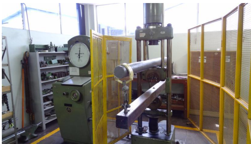
Foto 9 – Ensaio de flexão na nova cruzeta, nos laboratórios da Cemig em Belo Horizonte, MG.
