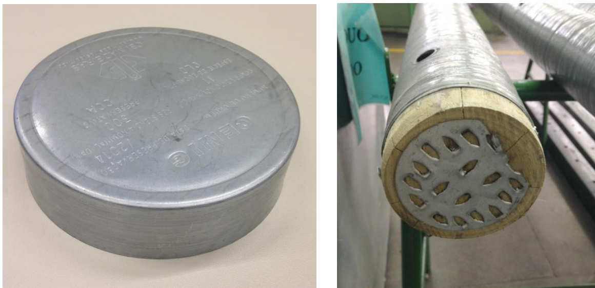
Fotos 7 e 8 – Tampa de alumínio, com informações da cruzeta e, abaixo da mesma, a placa antifendilhamento.
